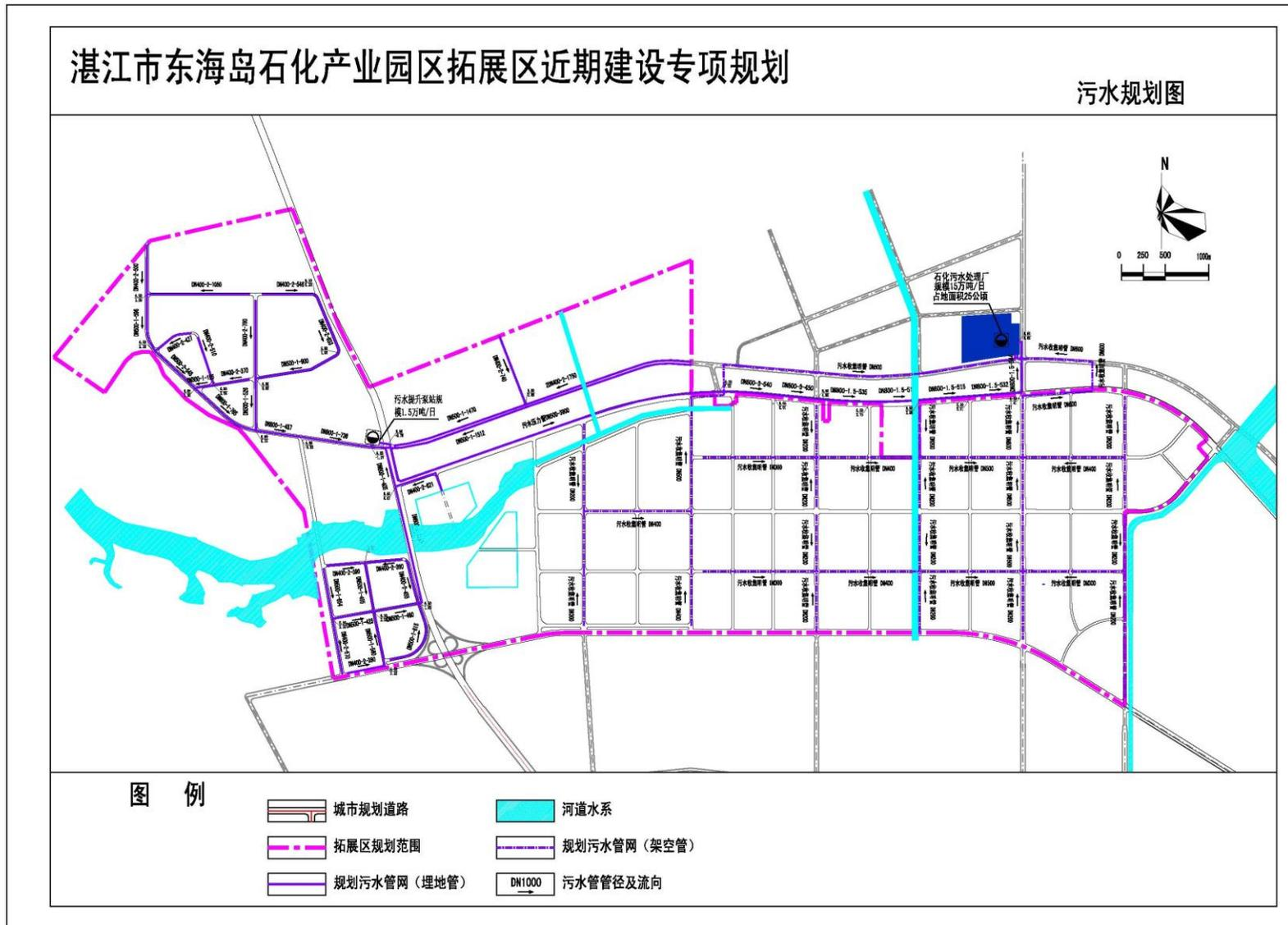
图 4-11 东海岛石化产业园扩园区域污水工程规划
