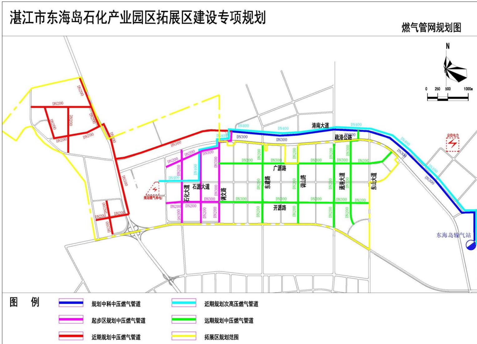
图 4-12 东海岛石化产业园扩园区域燃气工程规划
