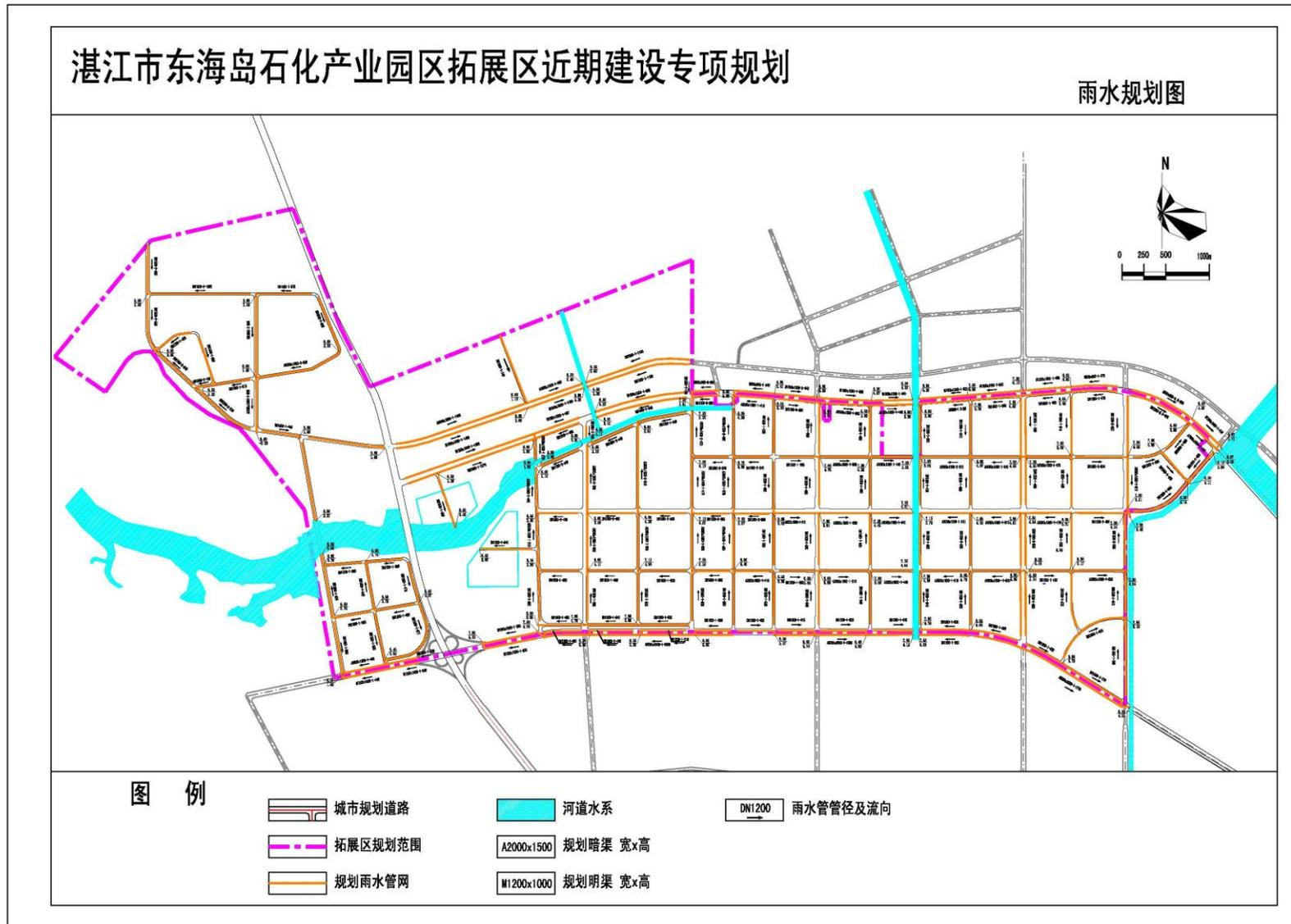
图 4-10 东海岛石化产业园扩园区域雨水工程规划
