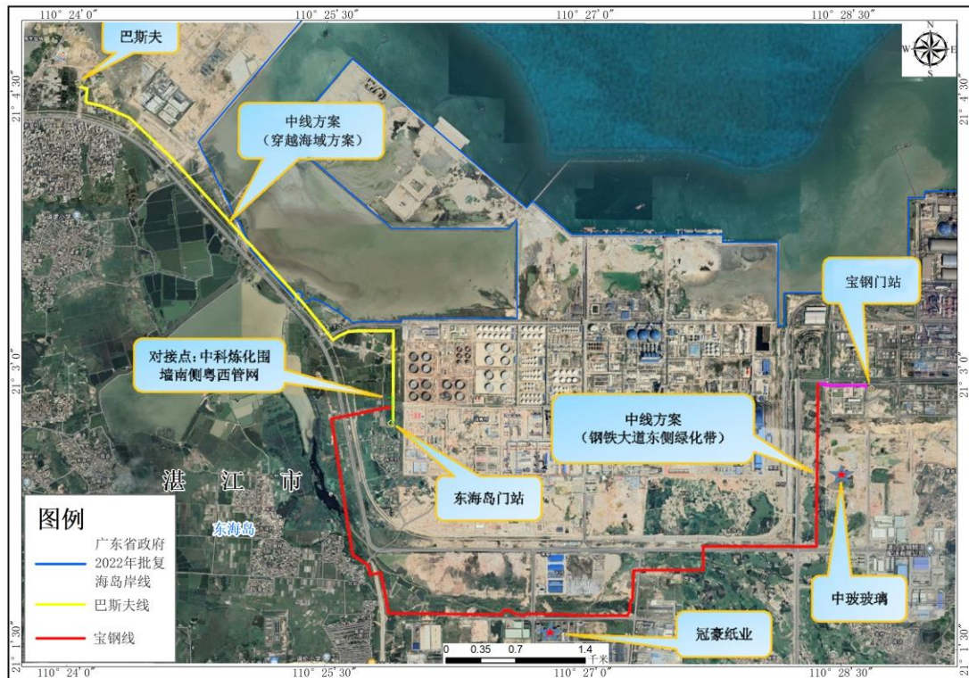
图 2.1.2-1 项目天然气管道总体走向图
