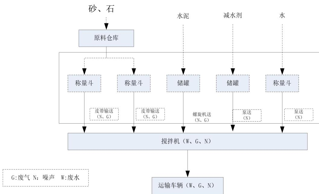
图 3 预拌商品混凝土工艺流程及产污示意图
