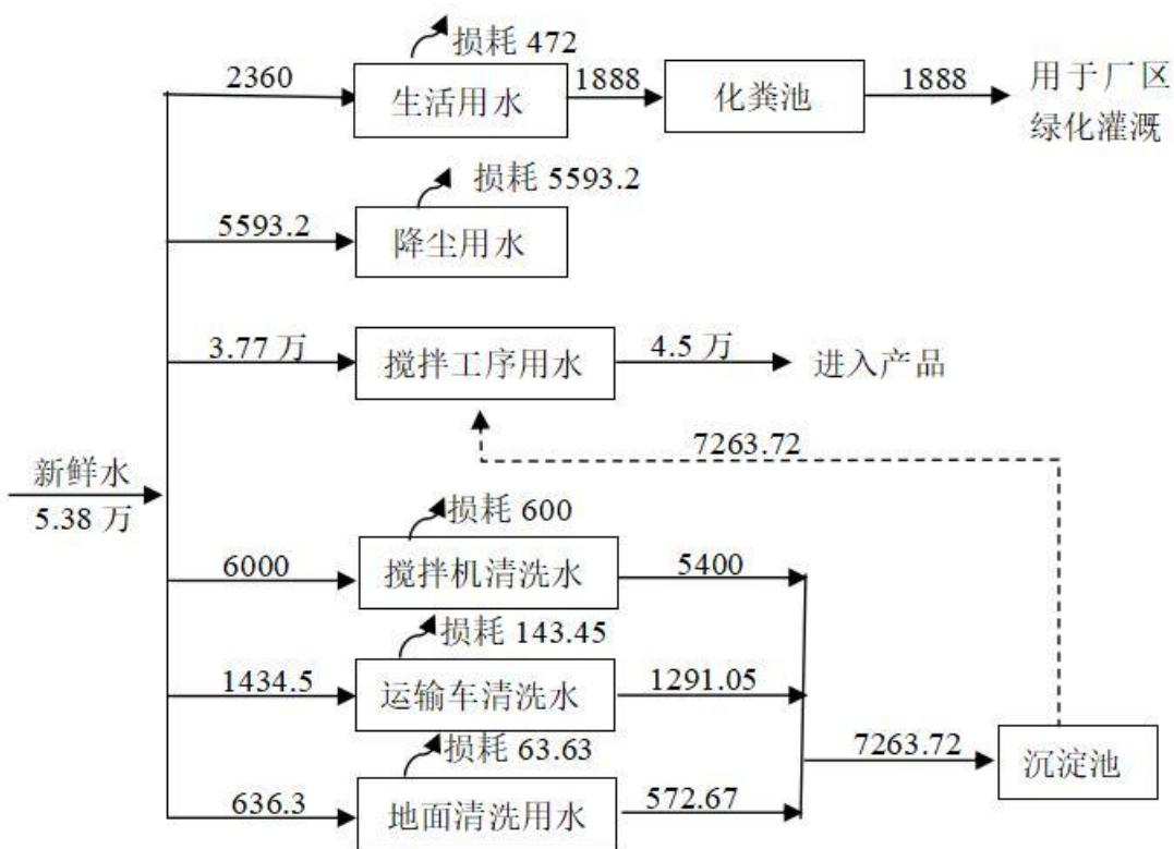
图1 扩建项目水平衡图 (单位:  $\text{m}^3/\text{a}$ )
