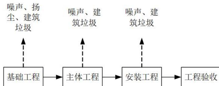
图 2 施工期工艺流程及产污示意图
