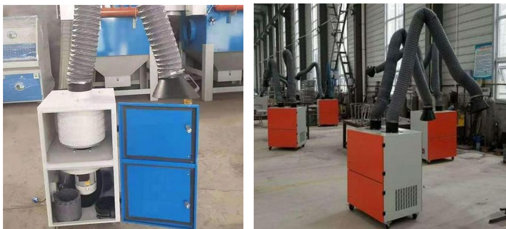
图 4-1 典型移动式滤筒除尘器样式
