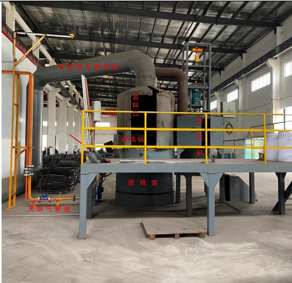
图 2-3 本项目熔锌炉图片
