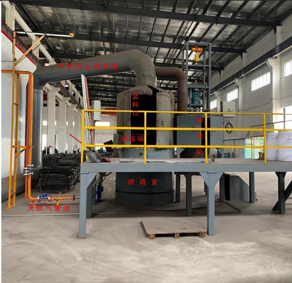
图 2-3 本项目熔锌炉图片
