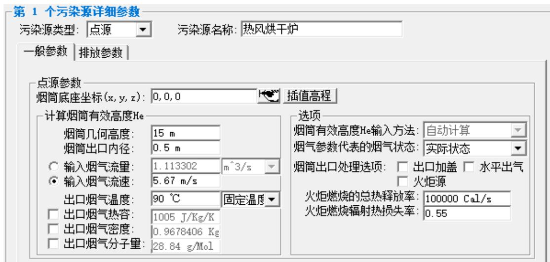
热风烘干炉污染源一般参数输入截图。
