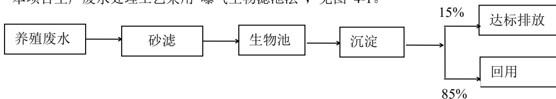
图 4-1 循环净化系统处理工艺流程图
